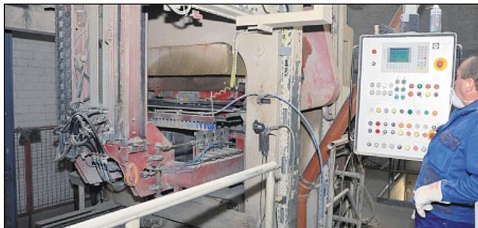
Die Kalk-Sand-Wasser-Mischung wird zunächst als Rohling gepresst und dann computergesteuert exakt zugeschnitten.
