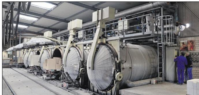
Durch Dampf und bei einer Temperatur von 200 Grad Celsius läuft ein chemischer Prozess ab, der die Kalksandstein-Rohlinge härtet.
